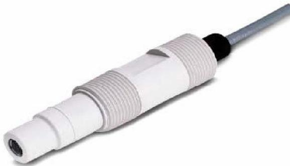
Датчики pH/ОВП Rosemount 396P и 396PVP имеют усиленный полипропиленовый корпус с резьбами 1"MNPT, спереди и позади электрода, предназначенный для вставки, погружения и проточного монтажа. Датчик Rosemount 396P имеет встроенное кабельное соединение, а датчик Rosemount 396PVP – кабельное соединение Varipol для использования с соединительными кабелями VP8 (продаются отдельно; см. разделе «Дополнительное оборудование»).
