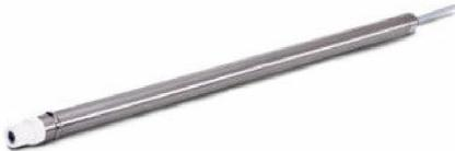
Датчики pH/ОВП Rosemount 396R и 396RVP имеют длину титановой трубки 21 дюйм (533,4 мм) и 36 дюймов (914,4 мм) для использования с шаровым краном (продается отдельно) для ввода/извлечения датчика без остановки процесса. Rosemount 396RVP имеет кабельное соединение Variopol для использования с быстроразъемными соединительными кабелями VP8 (продаются отдельно; см. разделе «[Дополнительное оборудование](#)»).
