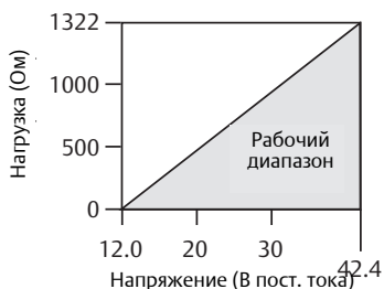
Рис. 1-17. 3051SHP с расширенной диагностикой HART (Код опции DA2), и 3051SHP с измерением разности давлений и температуры
