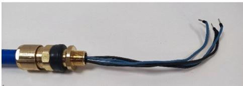
2. Проложите провода через корпус устройства. Затягивайте сальник на корпусе до полного соприкосновения с корпусом устройства. С помощью 24-миллиметрового ключа обеспечьте полную затяжку сальника в соответствии с инструкциями производителя.
