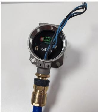
3. Извлеките разъем из гнезда внутри устройства.
