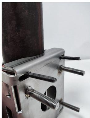
3. Наденьте шайбу и гайку на U-образный болт и затяните до упора вручную. Затем затяните гайки на U-образных болтах до момента 3 Н·м. Совершайте по ¼ оборота за раз, пока все гайки не будут затянуты до момента 3 Н·м.
