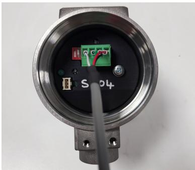
2. Подключите конфигурационный кабель к планшету или компьютеру, на котором установлено приложение для ввода в эксплуатацию.
