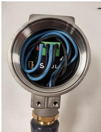
5. Установите крышку на корпус устройства. С помощью ключа для крышки затяните крышку до упора (крышка должна быть плотно прижата к корпусу устройства).
