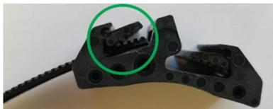
7. Затяните ремень рукой, чтобы датчик без напряжения удерживался на месте. При необходимости отрегулируйте положение датчика таким образом, чтобы он был корректным образом выровнен по окружности трубы. При наличии нескольких датчиков на ремне между башмаками соседних датчиков должен быть зазор.
