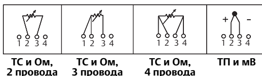
Схема подключений первичных преобразователей к Rosemount 648 Wireless
