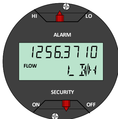
Рисунок 4-9. Переключки аварийной сигнализации и безопасности ЖК-индикатора (с опцией ЖКИ)
