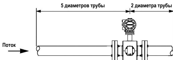
Рис. 3. Прямолинейный участок трубопровода до и после расходомера
