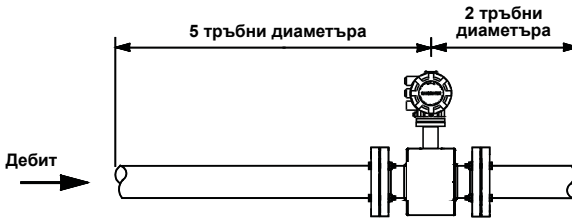
Фигура 3. Възходящи и низходящи прави тръбни диаметри
