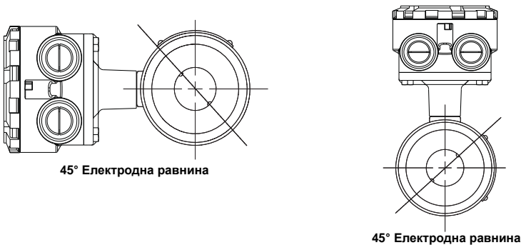
Фигура 5. Монтажна позиция на Rosemount 8711
