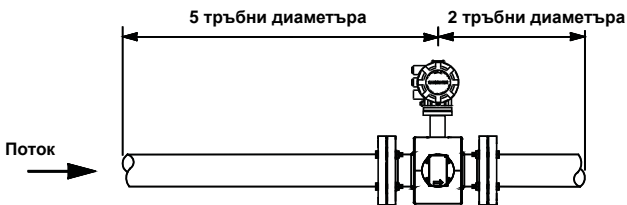
Фигура 3. Възходящи и низходящи прави тръбни диаметри
