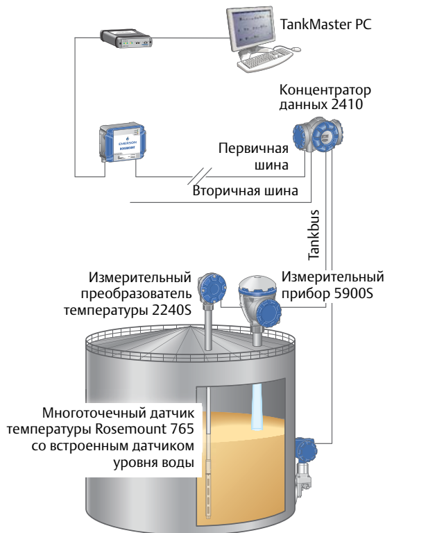
Многоточечный датчик температуры Rosemount 765, установленный с измерительным преобразователем температуры с несколькими входами Rosemount 2240S в системе Tank Gauging System
