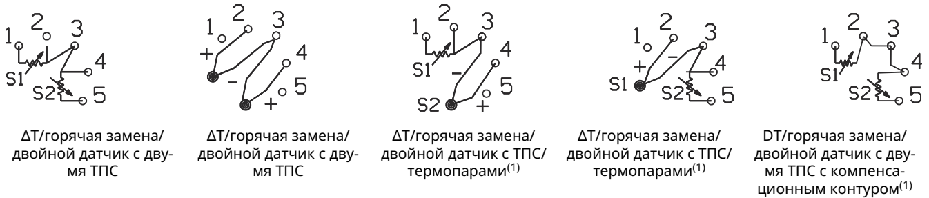
Подключение Rosemount 3144P с двойным датчиком
