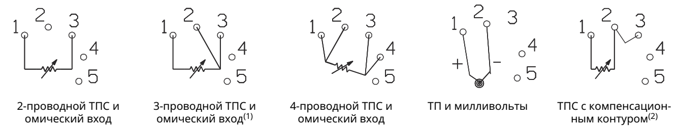
Подключение Rosemount 3144P с двойным датчиком
