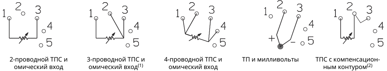
Подключение Rosemount 3144P с двойным датчиком
