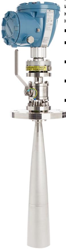
Модель Rosemount 5900C с антенной для СНГ/СПГ — это бесконтактный радарный уровнемер для измерения сжатого или криогенно-сжиженного газа. Сигналы радара передаются в успокоительный колодец, обеспечивая уровнемер отражением, достаточно сильным даже в условиях турбулентности, например кипящей поверхности.
