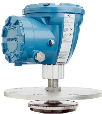
Модель Rosemount 5900C с решетчатой антенной — это бесконтактный радарный уровнемер для измерений в успокоительном колодце. Выпускается в двух вариантах: фиксированном и с люком на шарнирах. Типовой областью применения являются резервуары для сырой нефти с плавающей крышей и резервуары для бензина/нефтепродуктов как с плавающей крышей, так и без нее.
