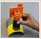
4. Отрежьте строп на требуемую длину. Она зависит от диаметра трубы. Если диаметр трубы равен D см / дюймов, приблизительную длину можно вычислить по формуле 3 x (D + 10) см (или 3 x (D + 4)
