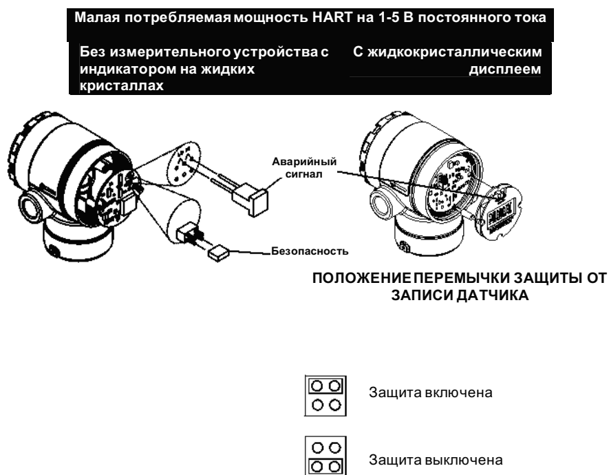
Рисунок 2-13. Электронные платы датчика с малой потребляемой мощностью.
