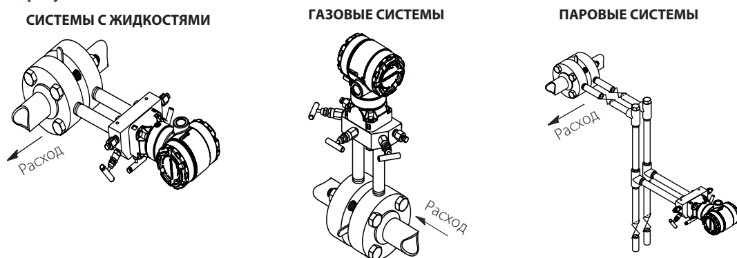
Рисунок 3-8. Примеры установки
