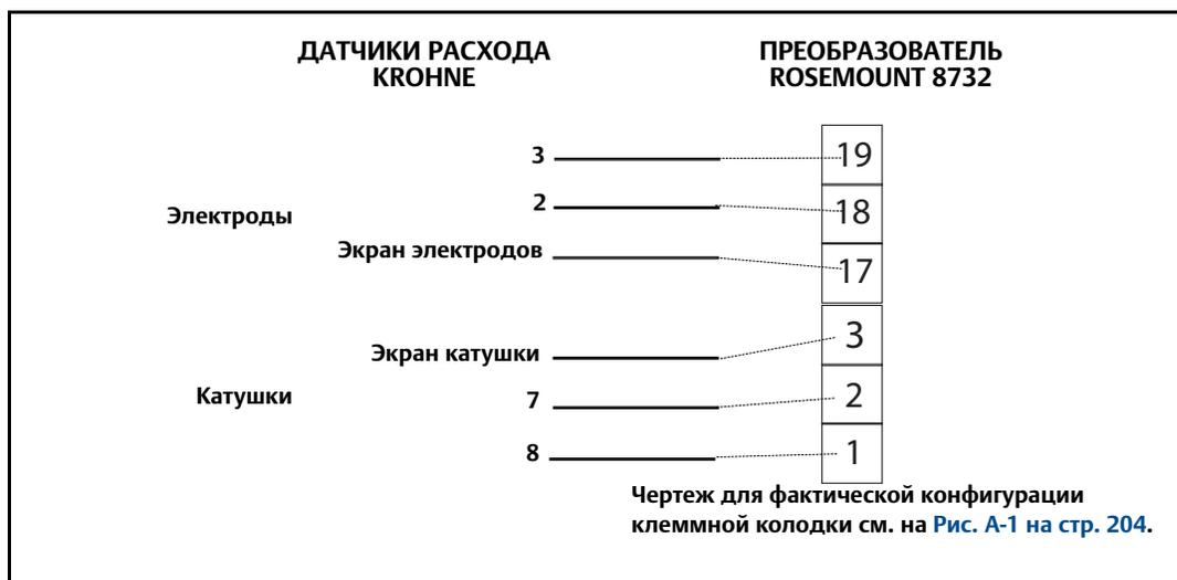
Табл. А-20. Подключение датчика расхода Krohne
