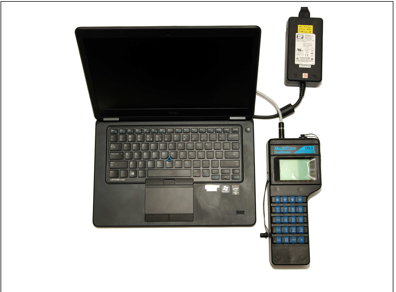
Рисунок 6 Загрузка данных с устройства ручного съема MultiCorr на компьютер с установленным ПО MultiTrend для мониторинга коррозии.
