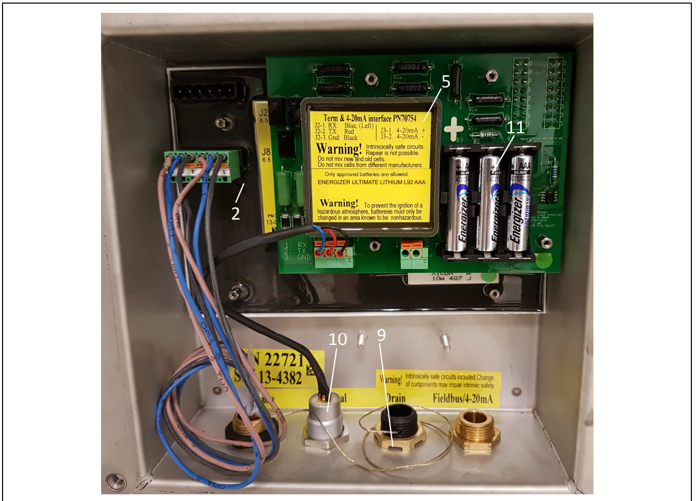
Рисунок 19 Перечень запасных частей для регистраторов CorrLog и SandLog. Позиционные обозначения соответствуют Таблица 23.
