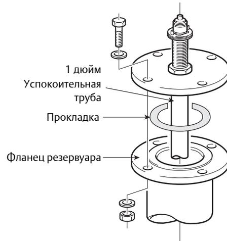
5. Вставьте трубку волновода в адаптер и установите защитную гильзу на фланец.
