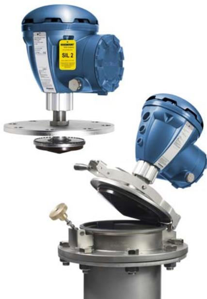
Rosemount 5900C с антенной для успокоительных труб является бесконтактный радарным уровнемером для проведения измерений в успокоительной трубе. Имеются два исполнения продукта: фиксированное и для откидного люка. Обычно применяется в резервуарах для сырой нефти с плавающими крышами и резервуарах для бензина и аналогичных продуктов, имеющих или не имеющих внутренние плавающие крыши.
