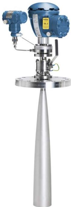
Rosemount 5900С с антенной для сжиженного нефтяного/сжиженного природного газа (СНГ/СПГ) является бесконтактным радарным уровнемером для измерений сжиженного газа под давлением или криогенного сжиженного газа. Сигналы радара передаются внутри успокоительной трубы, что позволяет измерительному прибору получать достаточно сильный отраженный сигнал, даже если поверхность продукта находится в состоянии кипения.
