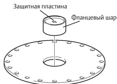
4. Убедитесь, что фланцевый шар установлен канавкой вверх, если фланец монтируется на горловину резервуара.
