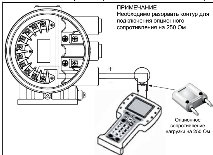
Рисунок F-3. Соединение полевого коммуникатора HART с опционным сопротивлением нагрузки
