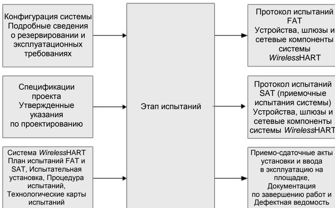
Рисунок 17: Испытания после выполнения работ
