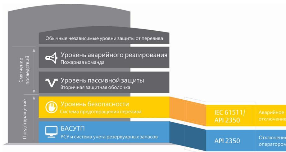
Независимые уровни защиты, используемые для предотвращения перелива и смягчения последствий аварии
