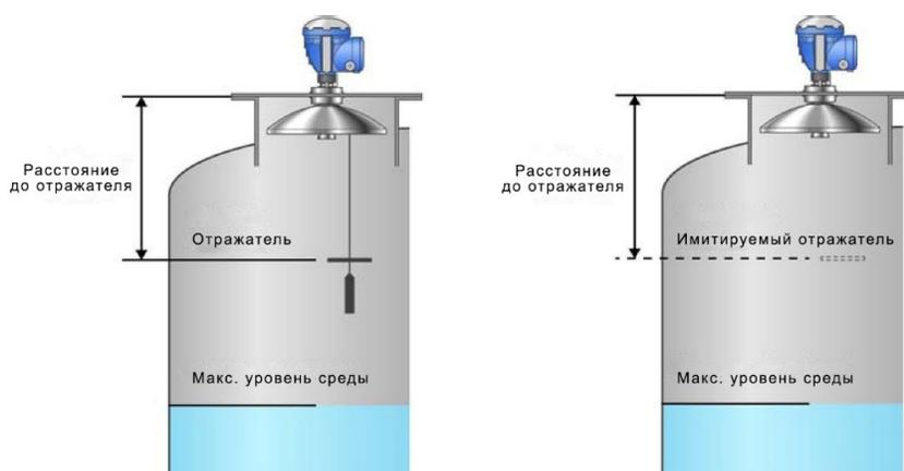
*Проверку сигнализации высокого уровня можно выполнить с помощью отражателя или за счет его имитации*
