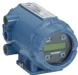
クラス最高の性能を持つ Rosemount 8732EM トランスミッタは、高度な診断機能と圧倒的なプロセス管理能力を備えています。オプションでバックライト付き 2 行 16 文字ディスプレイ/ローカル・オペレータ・インターフェースも利用可能です。トランスミッタは光学スイッチによって設定できるため、危険な環境でもカバーを取り外さずに簡単に調整できます。
