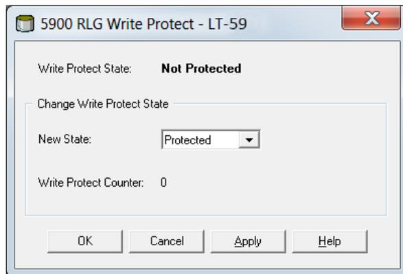
5. **New State (新しい状態)** ドロップダウンリストで、**Protected (保護)** を選択してから、**Apply (適用)** ボタンをクリックして、現在の書き込み保護状態を保存します。これで保持レジスタのデータベースがロックされました。機器が書き込み保護されている限り、構成変更はできません。
