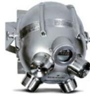
艾默生的 Incus 是一款高级超声气体泄漏检测系统，利用四个超敏感声音传感器，持续监测大范围区域内因加压气体释放而产生的超声。非常适合在通风良好的户外环境中进行监控。
