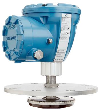
Rosemount 5900C アレイ アンテナ付はスチルパイプ測定用非接触レーダー レベルゲージです。固定ハッチとヒンジハッチの二種類のバージョンが入手可能です。代表的な用途には、浮き屋根の原油タンクと、内部に浮き屋根が付いたまたは付いていないガソリン/製品タンクがあります。
