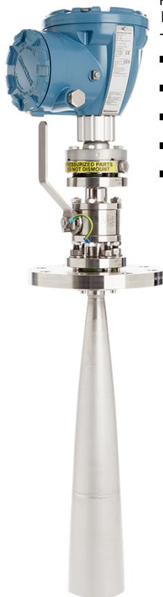
Rosemount 5900C LPG/LNG アンテナは、加圧または極低温液化ガス測定用の非接触レーダー レベルゲージです。レーダー信号はスティールパイプの内側を伝播するので、表面が沸騰などで荒れた状態でもゲージは十分に強いエコーを得ることが可能です。
