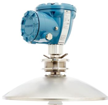
Rosemount 5900C パラボラアンテナは非接触レーダー・レベル・ゲージです。パラボラアンテナはスチルパイプのない固定ルーフタンクへの設置に最適です。狭いレーダー照射とノイズ比の高い信号により、既存のマンホールカバーやタンク壁の近くにも設置可能です。特別なケースでは、浮屋根タンクで浮屋根上の標的板の距離を計測することにも使用可能です。
