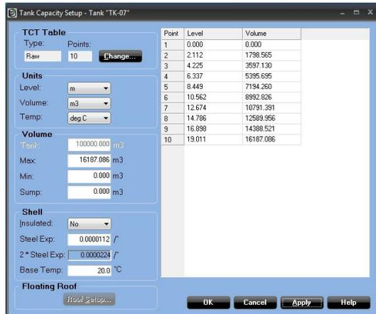
Rosemount タンクゲージシステムには、高精度な測定と計算に使われる次のような機器があります。
