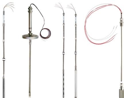
3 線式および 4 線式の校正済み温度センサと水尺測定 センサ/トランスミッタあたり最大 16 個の Pt-100 スポットエレメント製品温度の測定には、完全浸漬した素子のみが使用されます。各センサは Rosemount 2240S トランスミッタに接続されます。
