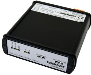
Rosemount 2180 Fieldbus モデムは、Rosemount タンクゲージのフィールド機器または Rosemount 2460 システムハブからの TRL2 Fieldbus と制御室の Rosemount TankMaster PC を接続するために使用します。本モデムは RS232 または USB インターフェースのいずれかを使って PC に接続されます。
