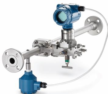
Rosemount 3051CFP インテグラルオリフィス流量計は、小径配管で高精度の流量測定を可能にします。インテグラルオリフィス流量計は、精度を高めるために配管部に精密なホーニング加工を施し、セルフセンタリングプレート設計により、小口径配管で測定誤差が拡大する原因となる不正確なセンタリングを防止します。
