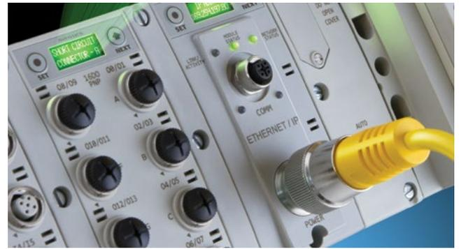
이더넷 및 fieldbus 연결은 밸브 상태 정보 접근을 제공하여 장애를 빨리 식별하고 유지보수 일정을 개선합니다. ▶ p14
