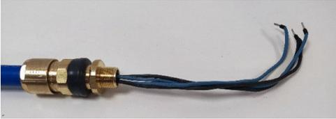
2. 장치 하우징을 통해 배선합니다. 글랜드가 장치 하우징과 완전히 접촉할 때까지 글랜드를 하우징에 조입니다. 제조업체의 지침에 따라 24mm 스패너를 사용하여 글랜드를 완전히 조입니다.
