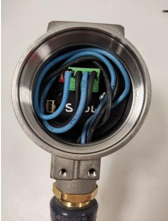
5. 장치의 하우징의 뚜껑을 교체합니다. 뚜껑 스패너를 사용하여 더 조일 수 없을 때까지 뚜껑을 조입니다(뚜껑은 장치 하우징에 접지되어야 함).
