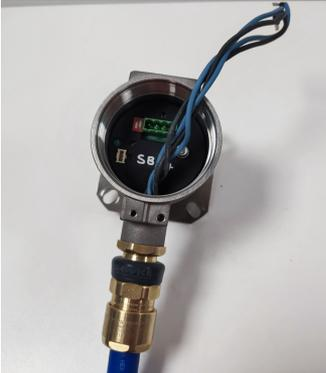
3. 장치 내부의 소켓에서 연결부를 제거합니다. 4개의 도체를 연결부에 연결하여 제어 시스템 측의 전원 및 데이터 연결과 일치하도록 합니다. 왼쪽부터 오른쪽으로 연결은 다음과 같습니다. 통신 -ve, 통신 +ve, 전원 -ve, 전원 +ve
