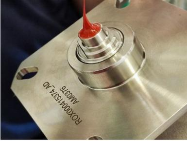
2. 장착 소켓의 스테드가 장치 플랜지의 구멍을 통과하도록 장치를 장착 소켓에 놓습니다. 도파관이 파이프와 접촉할 때까지 장치를 밀어서 Loctite 5990이 균일하게 퍼지는지 확인합니다.
