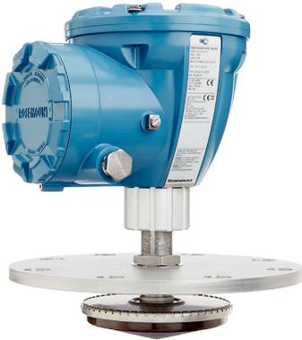
어레이(Array) 안테나가 장착된 Rosemount 5900C는 스틸 파이프 측정을 위한 비접촉 레이더 레벨 게이지입니다. 고정식 및 힌지 해치, 두 가지 버전으로 제공됩니다. 일반적으로 플로팅 루프가 있는 원유 탱크와 내부 부동 루프가 있거나 없는 가솔린/제품 탱크에서 사용됩니다.
