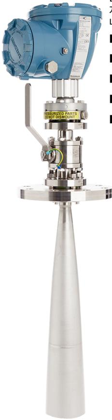
LPG/LNG 안테나가 장착된 Rosemount 5900C는 가압 또는 극저온 액화 가스에서 측정하기 위한 비접촉 레이더 레벨 게이지입니다. 레이더 신호는 게이지가 매우 뜨거운 표면과 같은 와류 조건 하에서도 충분히 강한 에코를 낼 수 있도록 스틸 파이프 내에서 전송됩니다.
