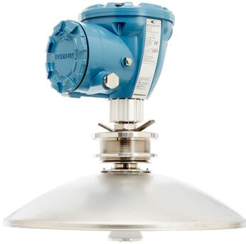
파라볼릭 안테나가 장착된 Rosemount 5900C는 비접촉 레이더 레벨 게이지입니다. 스틸 파이프 없이 고정 루프가 있는 탱크에 설치할 경우 파라볼릭 안테나가 첫 번째 선택입니다. 좁은 레이더 빔과 높은 신호 대 잡음 비로 인해 기존 맨홀 커버 및 탱크 벽 가까이 설치할 수 있습니다. 특정한 경우, 플로팅 루프가 있는 탱크에 사용하여 부동 루프의 목표 플레이트까지 하향 거리를 측정할 수 있습니다.
