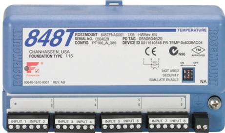
Rosemount 848T는 고밀도 측정에 대해 저비용 솔루션을 제공합니다. 트랜스미터는 8개의 독립 구성 가능한 센서 입력을 허용하며, 데이터 품질을 향상하기 위해 공정 가까이에 장착할 수 있습니다. FOUNDATION Fieldbus 아키텍처는 단일 H1 Fieldbus 라인에서 최대 128개의 온도 측정을 전송할 수 있습니다.
