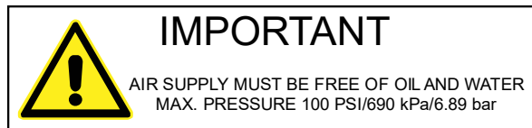
Rysunek 1.2 Etykieta ostrzegawcza umieszczona na wlocie sprężonego powietrza zespołu przesuwającego 2000Xc
