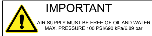
Figuri 1.2 Eticheta de atenționare aflată pe dispozitivul de acționare 2000Xc pentru alimentarea cu aer în fabrică
