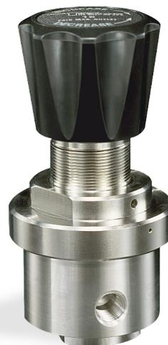
TESCOM 44-4700シリーズは、特殊媒体、可燃ガス、工業用ガスの低圧力および減圧を制御するための、超高感度かつ高純度の背圧調整弁です。拡散抵抗メタルステンレスシーリングなので、ガス純度とリーク完全性を保証できます。
