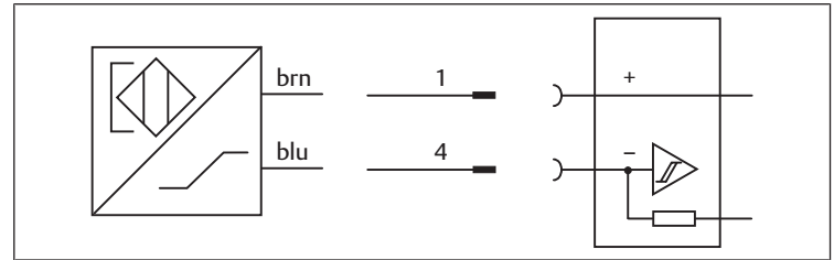
Рис. 1: Схема подключения датчика
