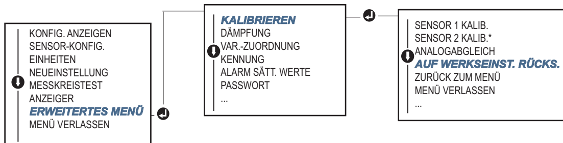
Abbildung 5-3. Zurücksetzen des Sensorabgleichs auf die Werkseinstellung mittels Bedieninterface
