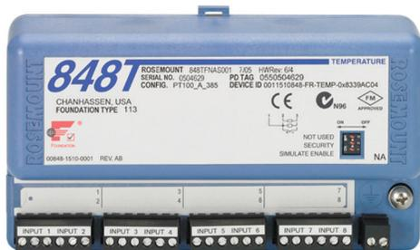
Il Rosemount 848T offre una soluzione a basso costo per misure ad alta densità. Il trasmettitore accetta otto ingressi del sensore configurabili indipendentemente e può essere montato in prossimità del processo per migliorare la qualità dei dati. L'architettura FOUNDATION fieldbus consente di trasmettere un massimo di 128 misure di temperatura su una singola linea fieldbus H1.
