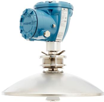
Il Rosemount 5900C con antenna parabolica è un misuratore di livello radar non contattivo. L'antenna parabolica è la scelta ideale per l'installazione su serbatoi con tetti fissi senza tubo di calma. Può essere installata su portelli esistenti e vicino alla parete del serbatoio, grazie al fascio radar stretto e all'elevato rapporto segnale/rumore. In alcuni casi può essere utilizzata su serbatoi con tetti flottanti per misurare la distanza da una piastra target sul tetto flottante.
