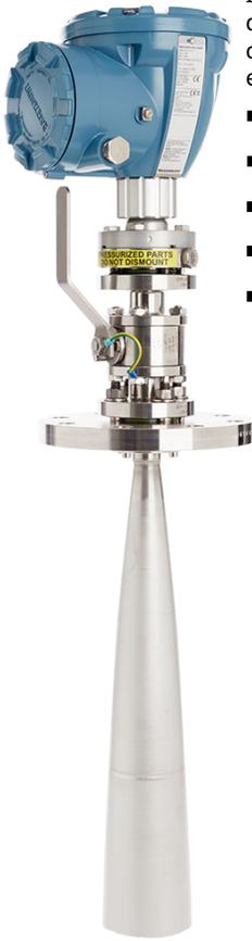
Il Rosemount 5900C con antenna per GPL/GNL è un misuratore di livello radar non contattivo per la misura di gas liquefatto pressurizzato o criogenico. I segnali radar sono trasmessi all'interno del tubo di calma, consentendo al misuratore di avere una eco sufficientemente forte anche in condizioni di turbolenza, per esempio con superficie in ebollizione.
