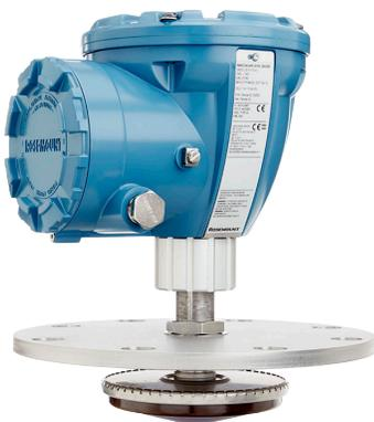
Il Rosemount 5900C con antenna array è un misuratore di livello radar non contattivo per la misura con tubo di calma. È disponibile in due versioni: con portello fisso e incernierato. Le applicazioni tipiche includono serbatoi di greggio con tetti flottanti e serbatoi di benzina/prodotto con o senza tetti flottanti interni.
