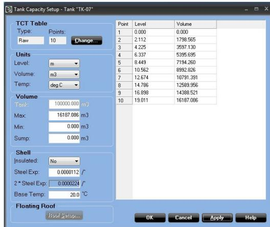
Il sistema di Tank Gauging Rosemount include apparecchiature per la misura e i calcoli ad alta accuratezza come:
