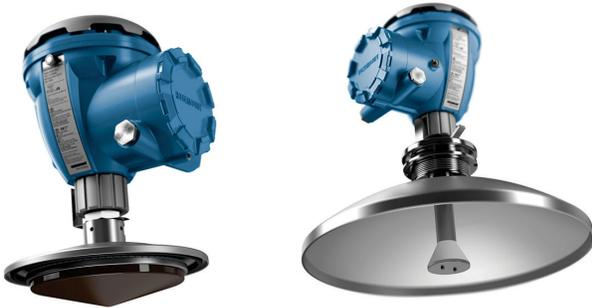
I misuratori di livello radar serie 5900 Rosemount con antenne paraboliche sono progettati per ambienti difficili, come i serbatoi di bitume. [Figura 11](#) mostra un'antenna in funzione dopo essere stata esposta a bitume insufflato a 220 °C (430 °F) per diversi mesi.
