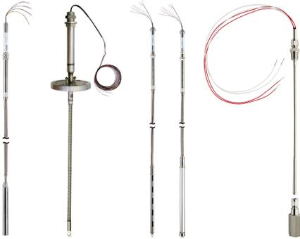
Sensori di temperatura calibrati a 3 o 4 fili e misura di livello dell'acqua libera. Fino a 16 elementi a punto singolo Pt-100 per sensore/trasmittitore. Solo gli elementi completamente immersi sono utilizzati per determinare la temperatura del prodotto. Ciascun sensore è collegato ad un trasmettitore 2240S Rosemount.
