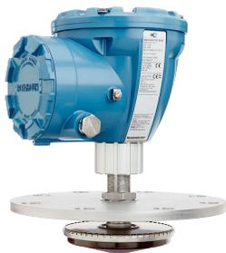
Il misuratore di livello radar 5900C Rosemount fornisce un'accuratezza dello strumento pari a  $\pm 1$  mm (0,04 in.). È generalmente associato con sensori di temperatura multipunto ad alta precisione per i calcoli del volume netto. È certificato SIL 2 a norma IEC 61508.
