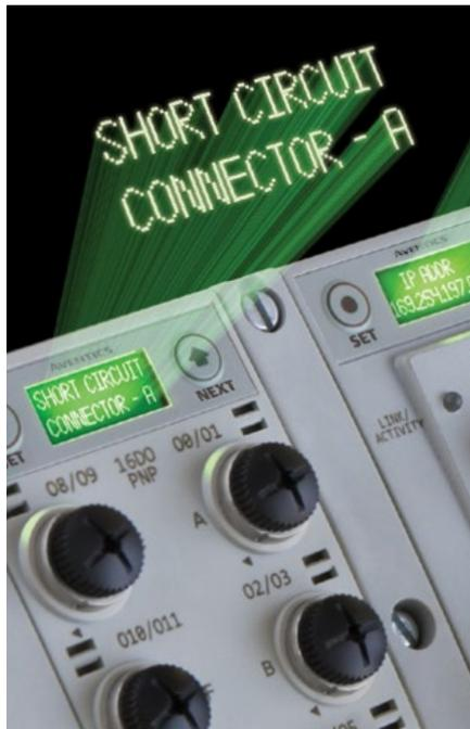
L'afficheur graphique permet d'obtenir un retour précis lors de la mise en service des îlots de distribution pneumatique, ce qui accélère le processus de mise en service et raccourcit vos délais de réalisation. ► p. 14
