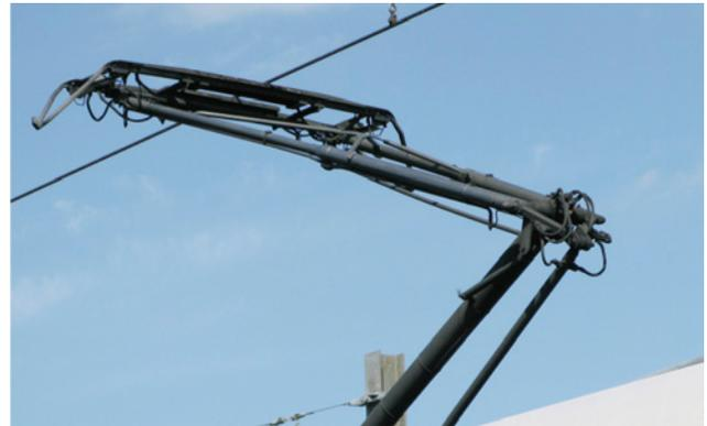
di presa contro il filo della linea elettrica, applicando la pressione corretta e rispettando le specifiche dei pantografi per i più svariati campi d'impiego. I componenti pneumatici sono appositamente concepiti per tutte le velocità e le inclinazioni in curva, nonostante nei singoli paesi vengano applicate tensioni differenti e vengano utilizzati pantografi dalle caratteristiche più svariate.
