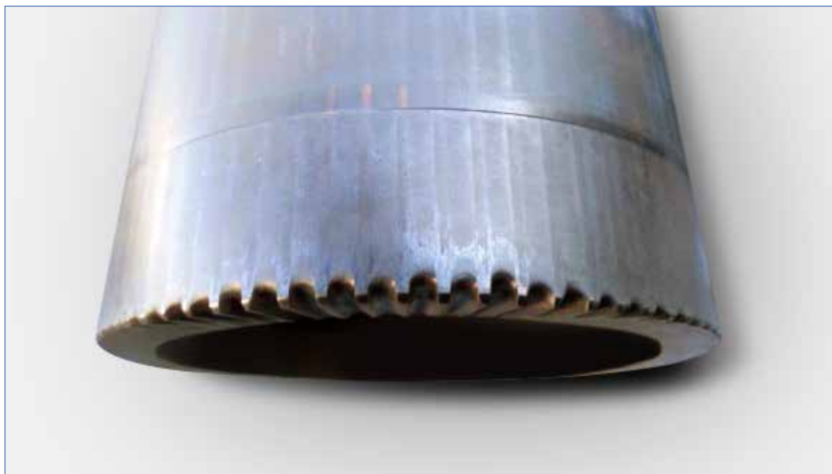
Dano ao obturador da válvula de controle, causado pelo vazamento com a válvula fechada.
