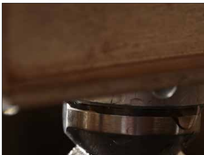
Padrão de pulverização de um bocal de pulverização atomizado mecanicamente, danificado.
