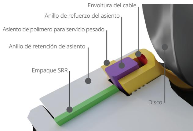
**Implemente el diseño de asiento K-LOK probado** que suministra un cierre de cero fugas conforme con EN 12266, independiente de la presión en la tubería. El diseño elimina casi todos los vacíos y, con ellos, la posibilidad de que se acumule el fluido. Esto permite que la válvula ofrezca el mismo desempeño de sellado superior a una presión muy baja y en servicios exigentes que contienen partículas.
