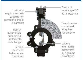
**Semplifica i tuoi asset con valvole** grazie a una soluzione progettata per adattarsi al tuo impianto chimico. La valvola di tipo ad alette offre un servizio dead-end bidirezionale completo con una superficie di tenuta della flangia ininterrotta in conformità alla norma EN 12569. La valvola è progettata in base alle specifiche NAMUR NE 167, ISO ed EN con certificazioni PED e CE come standard.
