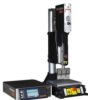
L'unité de soudage par ultrasons Branson 2000Xd est adaptée aux conditionnements souples et individuels de spiritueux. Elle comprend les fonctionnalités et modes de soudure les plus avancées de Branson, dont les modes énergie, distance, puissance de crête et temps. Pour les applications critiques nécessitant un réglage précis, vous pouvez définir l'amplitude via l'indicateur numérique ou avec la fonction de modification du profil brevetée par Branson.
