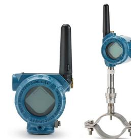
Ce transmetteur de température sans fil est d'une fiabilité inégalée sur le terrain. Associé à la technologie Rosemount X-well™ et à la sonde sur collier de serrage Rosemount 0085, il achemine des mesures précises de la température du procédé à l'aide d'un algorithme de conductivité thermique directement intégré, ce qui évite l'utilisation d'un puits thermométrique ou d'un point d'insertion dans le procédé, pour une réduction significative des délais et des coûts d'installation.
