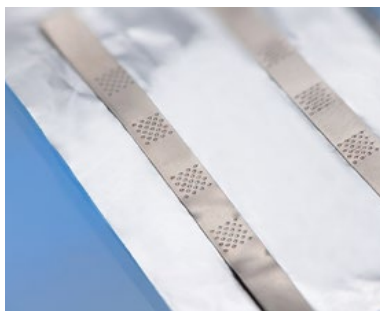
Batteria piccola: linguetta in alluminio + foglio in alluminio
