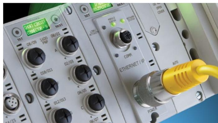
**La connessione Ethernet e Fieldbus** fornisce accesso alle informazioni sullo stato delle valvole consentendo alla manutenzione di identificare i guasti più rapidamente e migliorando la programmazione della manutenzione. ► p14
