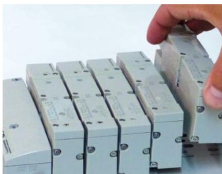
**Le valvole plug-and-play** possono essere sostituite rapidamente e con facilità, contribuendo a prevenire lunghe interruzioni della produzione. ► p14
