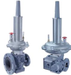
Reguladores de accionamiento directo ideales para aplicaciones industriales y comerciales que suministran gas a hornos, quemadores y otros aparatos. Un sistema de equilibrado permite que el regulador controle con precisión la presión del gas para obtener la máxima eficiencia de combustión a pesar de la variación en la presión de entrada.
