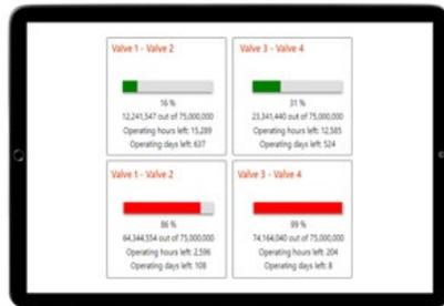
Die Softwarelösungen von Emerson ermöglichen die Lebenszyklusüberwachung von Dampfventilen mit Analysen zur Prognose von Störungen, bevor sie auftreten. Dies unterstützt vorausschauende Wartungsstrategien, indem das Wartungspersonal darauf aufmerksam gemacht wird, wann Ventile ausgetauscht werden müssen, um eine unzureichende Aushärtung zu verhindern, die in der Spätphase zu kostspieligen Reifenverschrottungen und Produktionsausfällen führt.
