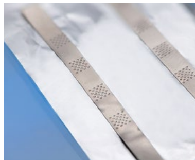
Kleine Batterie: Al-Tab + Al-Folie
