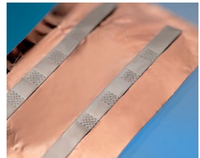
Kleine Batterie: Ni-Tab + Cu-Folie
